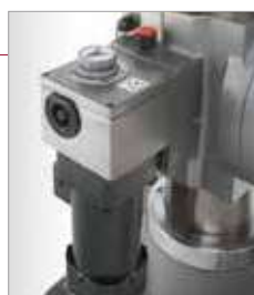
GBM 4/50: Schneckengetriebe für automatische Tischhöhenverstellung
