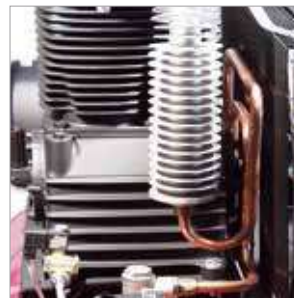
Kühler aus Alu- Druckguss und Kupferkühlleitung
