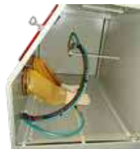
PAL Innenraum (Injektorsystem)
