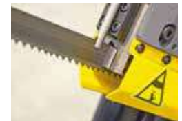
Sägebandführung aus Hartmetall
