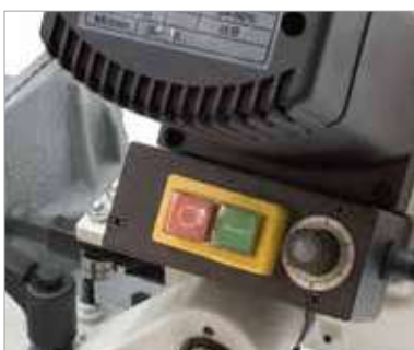
Stufenlos einstellbare Schnittgeschwindigkeit mit Drehregler SGR
