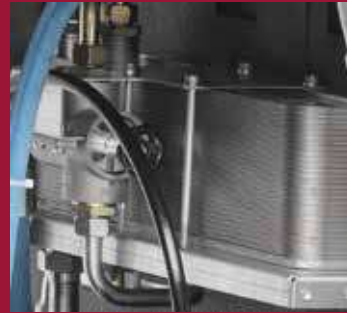
Wärmerückgewinnung zur Warmwasseraufbereitung
