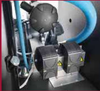
Schalldämmhauben-Heizung: Für Anlagen bei niedriger Umgebungstemperatur
