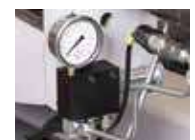
Spanndruckregelung des Spannstockes
