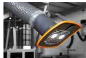
Beleuchtungssatz inkl. Ein/Ausschalter für Beleuchtung und Maschine
