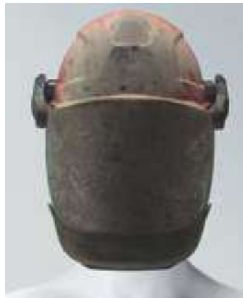
Nach 7 kA Störlichtbogen
