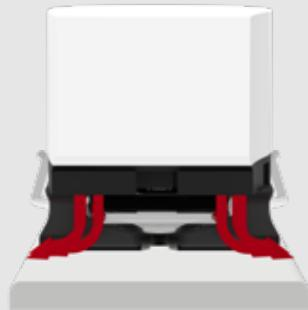
Die Abbildung zeigt die grundlegenden Eigenschaften des Spacers: Er verbindet die Sohle des Schuhs mit dem Ski und überträgt sowohl vertikale als auch Torsionslasten.
